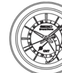
Para a direita : Atraso da hora (O ponteiro das horas gira para a esquerda.)
