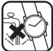
Wenn auf der Gehäuserückwand Ihrer Uhr nicht die Beschriftung „**WATER RESISTANT**“ vorhanden ist, ist sie nicht wasserdicht und muss vor Wasser geschützt werden, um Schäden am Uhrwerk zu vermeiden. Sollte die Uhr doch nass werden, empfehlen wir, die Uhr von einem **AUTORISIERTEN SEIKO-HÄNDLER** oder einer **KUNDENDIENSTSTELLE** überprüfen zu lassen.
